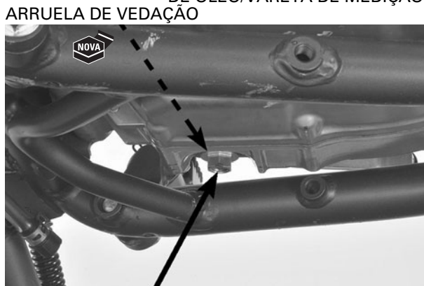
PARAFUSO DE DRENAGEM
