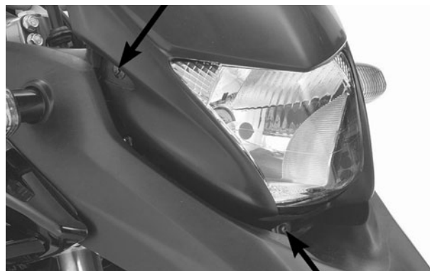
PARAFUSO DE AJUSTE
